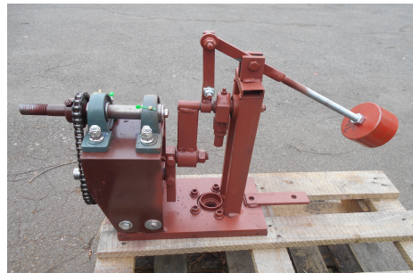
3-převod 1:2 s dovážením na páce
